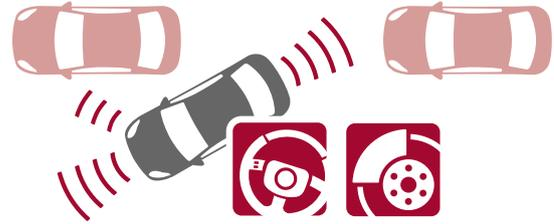
Der **Park- und Rangierassistent** erkennt Hindernisse rund um das Fahrzeug, inkl. den Fahrzeugseiten, und verhindert durch automatischen Bremseneingriff das Anstoßen an diese Hindernisse. Dabei wird die seitliche Bewegung des Fahrzeugs bei Lenkeinschlägen mit einbezogen. Der Park- und Rangierassistent deckt die z. B. in einem Parkhaus übliche Manövriergeschwindigkeit ab und funktioniert sowohl bei Vorwärts- als auch bei Rückwärtsfahrt.
