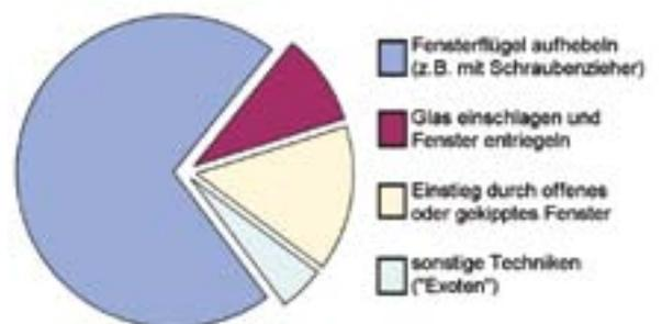
Abschließbare Fenstergriffe, wie sie häufig vorhanden sind, bieten alleine leider überhaupt keinen Schutz gegen das Aufhebeln. Sie verhindern lediglich ungewolltes Öffnen von innen. Und dass Täter die Scheibe einschlagen, um das Fenster anschließend mit dem Griff zu öffnen, kommt eher selten vor – in weniger als einem von 10 Fällen.
